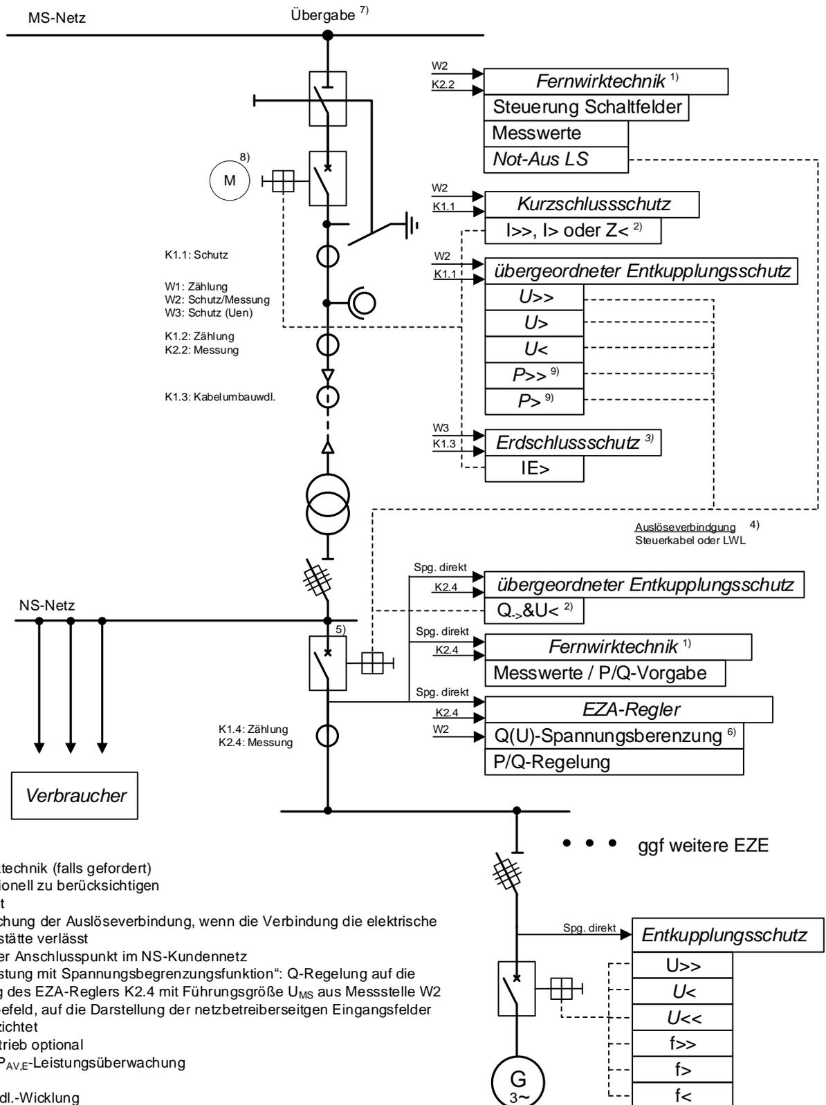
**Bild 9-Mischanlage** – Beispiel für eine an das Mittelspannungsnetz angeschlossene Kundenanlage mit Bezug und Erzeugungsanlage mit Lasttrennschalter und einer Erzeugungseinheit ohne Inselbetriebsmöglichkeit (Anschluss nicht in UW bzw. Schaltstation)
