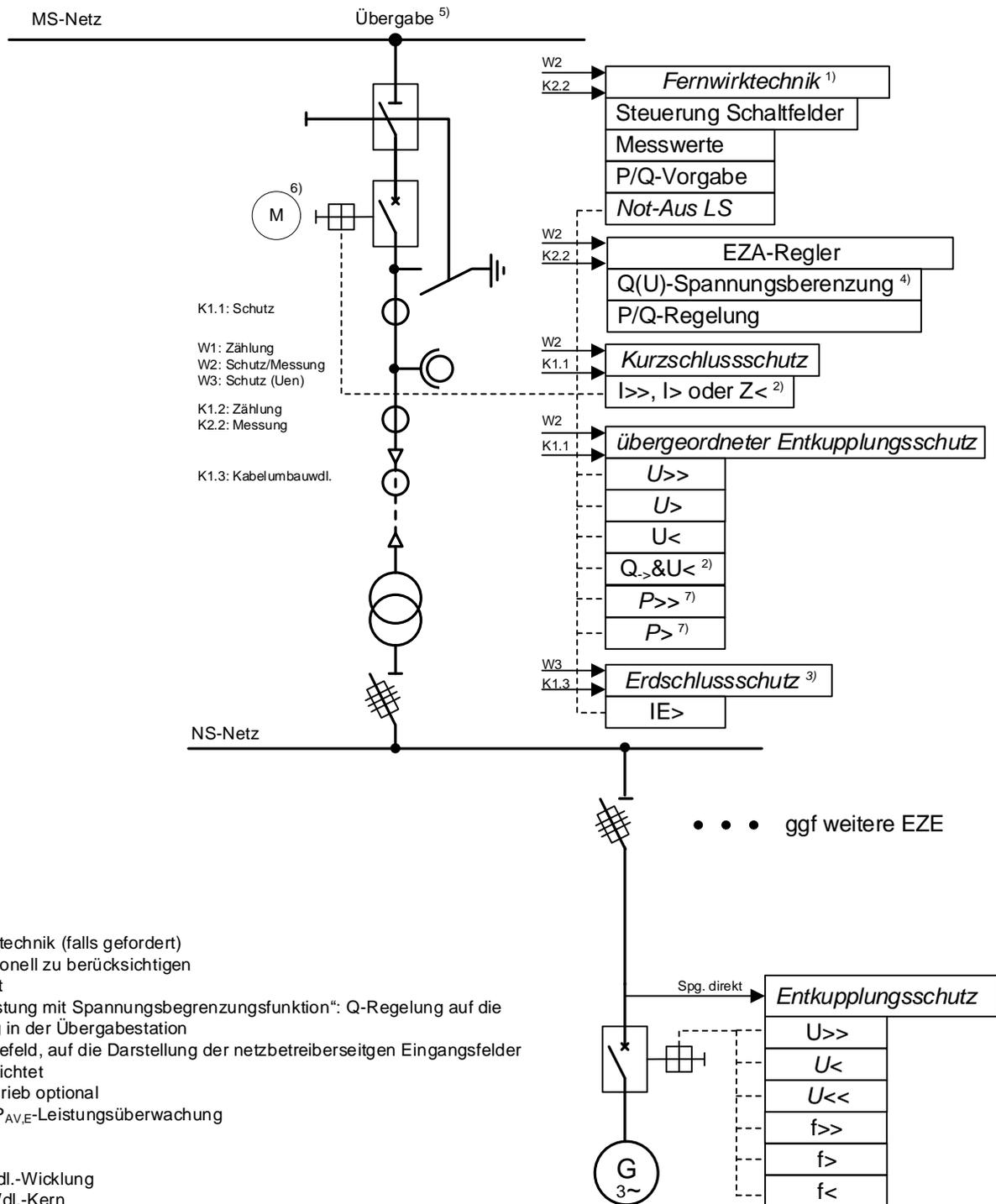
**Bild 11 Einspeisung** – Beispiel einer an das Mittelspannungsnetz angeschlossenen Erzeugungsanlage mit Lasttrennschalter und Erzeugungseinheit ohne Inselbetriebsmöglichkeit (Anschluss nicht in UW bzw. Schaltstation)
