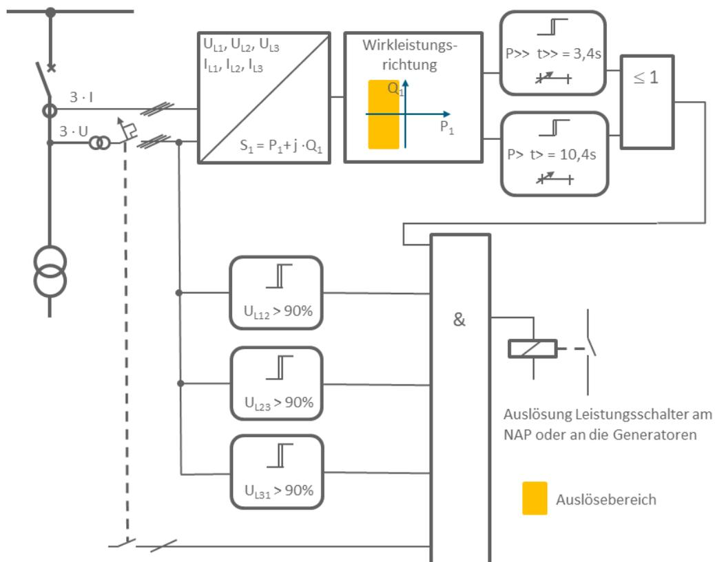
Bild 10.2: Schutzlogik für vereinbarte Anschlusswirkleistung P<sub>AV,E</sub> ≥ P<sub>min</sub>
