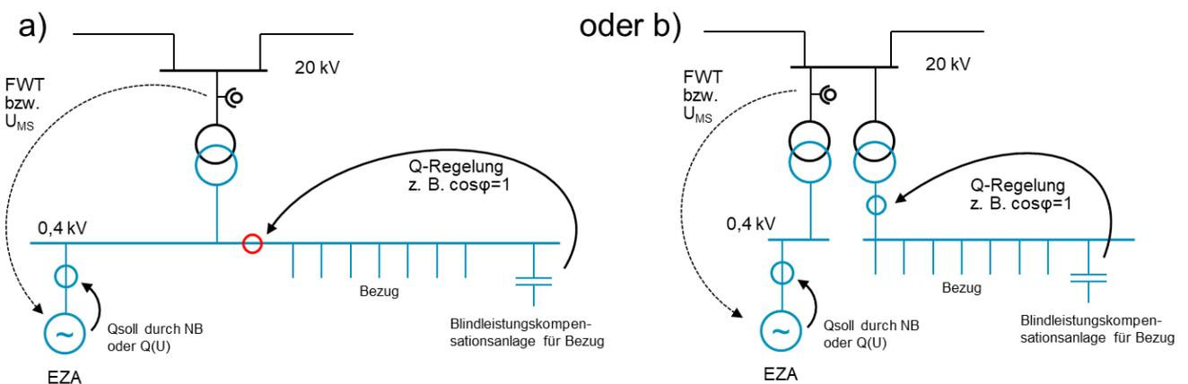
Bild L.2: Neuer Messpunkt misst nur Bezug, Beispiel a) innerhalb der NSHV und b) über separaten Transformator
