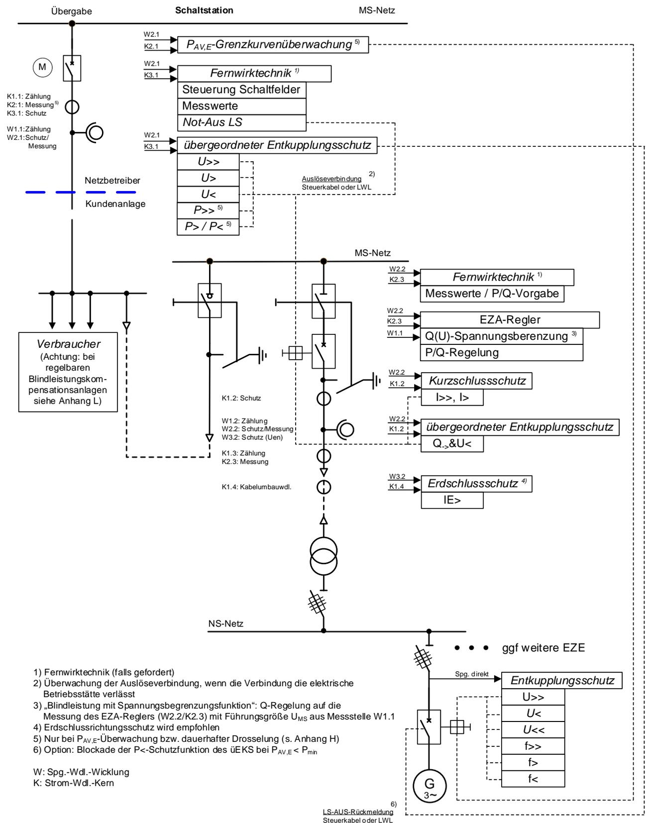
**Bild 18 Notstromaggregat mit zeitlich begrenzten Netzparallelbetrieb (Probetrieb) –** Beispiel eines an das Mittelspannungsnetz angeschlossenen Erzeugungsanlage als Notstromaggregat mit zeitlich begrenzten Netzparallelbetrieb (Probetrieb, Anschluss nicht in UW bzw. Schaltstation)
