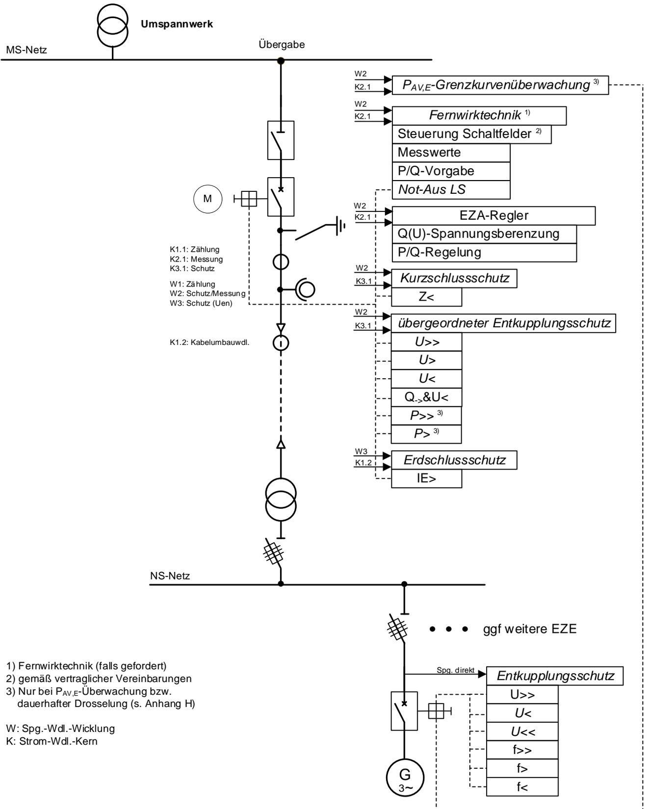
**Bild 14-Mischanlage** – Beispiel einer an ein **Umspannwerk** mittelspannungsseitig angeschlossenen Kundenanlage mit Bezug und Erzeugungsanlage mit Lasttrennschalter und einer Erzeugungseinheit ohne Inselbetriebsmöglichkeit
