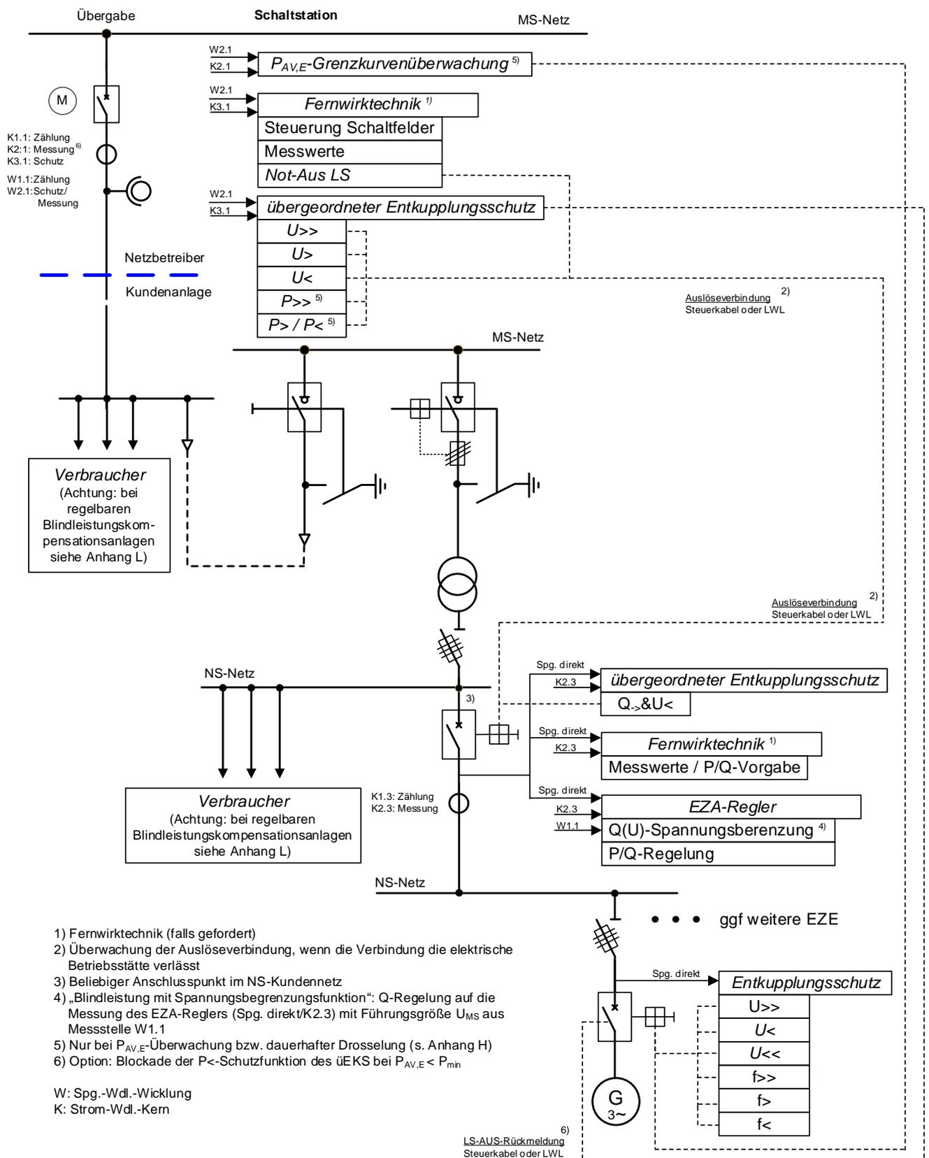
**Bild 17-Mischanlage** – Beispiel einer an eine **Schaltstation** im Mittelspannungsnetz angeschlossenen Kundenanlage mit Bezug und Erzeugungsanlage mit Leistungsschalter und einer Erzeugungseinheit ohne Inselbetriebsmöglichkeit
