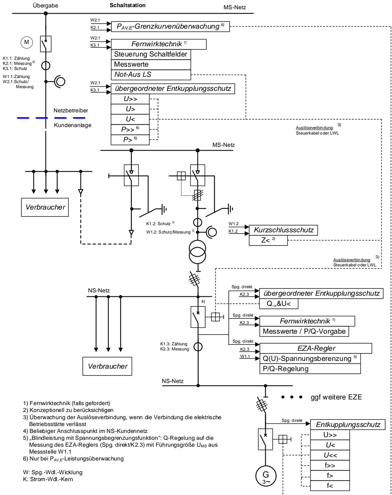
**Bild 17-Mischanlage** – Beispiel einer an eine **Schaltstation** im Mittelspannungsnetz angeschlossenen Kundenanlage mit Bezug und Erzeugungsanlage mit Leistungsschalter und einer Erzeugungseinheit ohne Inselbetriebsmöglichkeit
