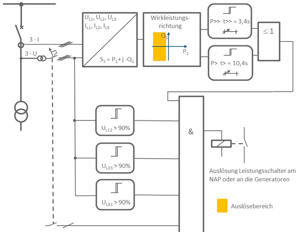
Bild 10.2: Schutzlogik für vereinbarte Anschlusswirkleistung  $P_{AV,E} \geq P_{min}$
