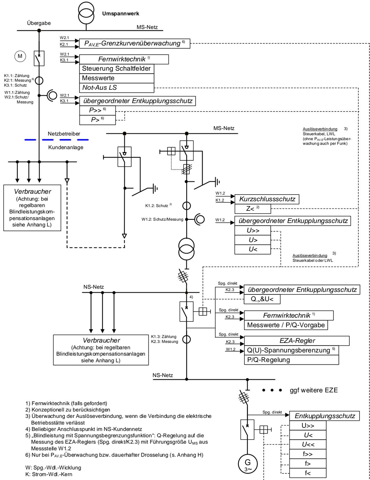
**Bild 15-Mischanlage** – Beispiel einer an ein Umspannwerk mittelspannungsseitig angeschlossenen Kundenanlage mit Bezug und Erzeugungsanlage mit Leistungsschalter und einer Erzeugungseinheit ohne Inselbetriebsmöglichkeit
