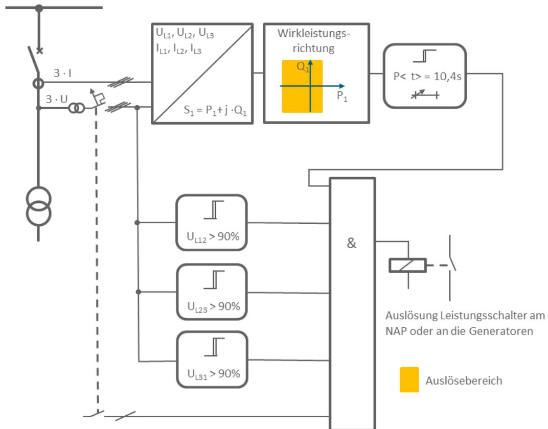
Bild 10.3 Schutzlogik für vereinbarte Anschlusswirkleistung  $P_{AV,E} < P_{min}$ .
