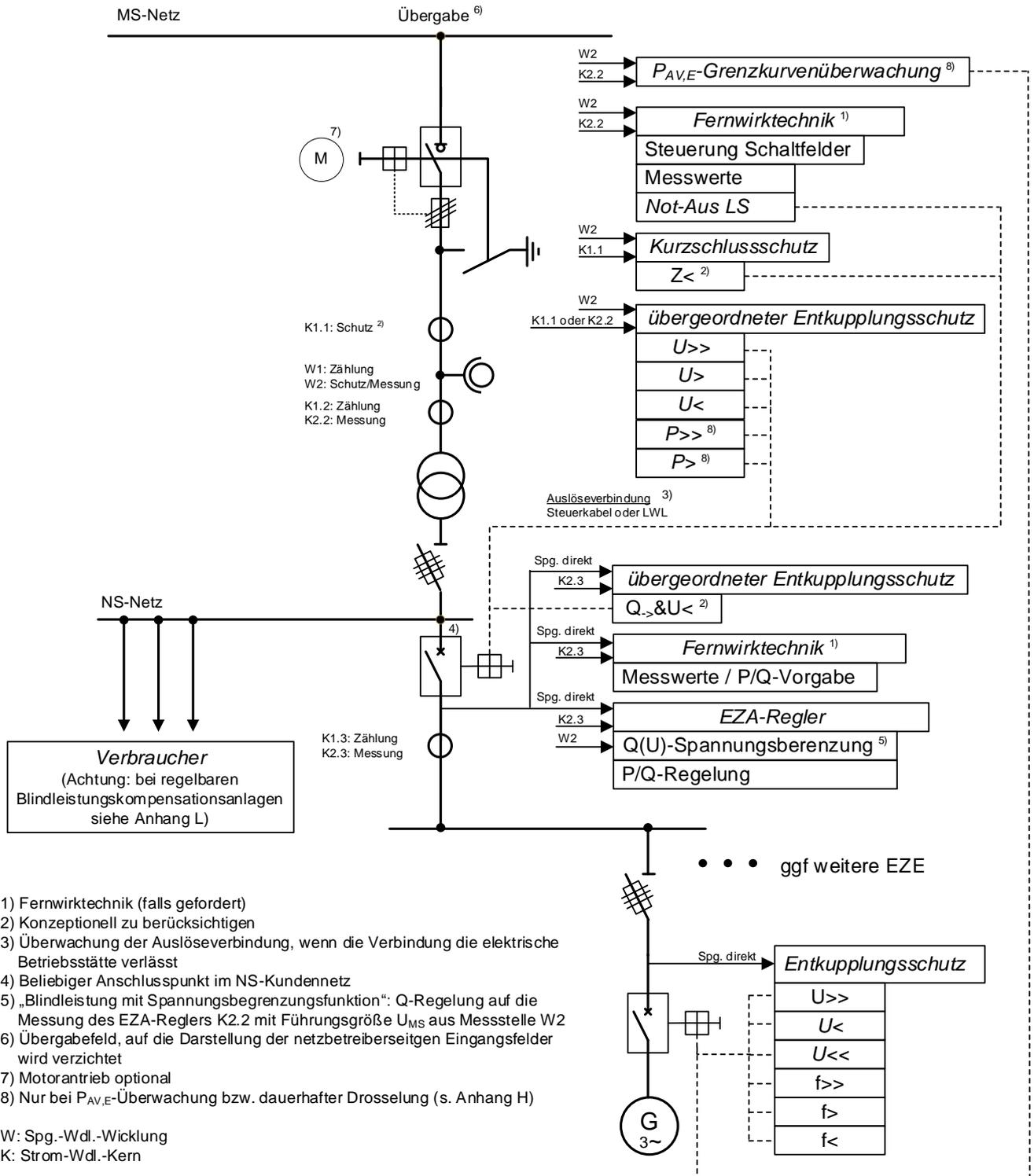
**Bild 10 Einspeisung** – Beispiel einer an das Mittelspannungsnetz angeschlossenen Erzeugungsanlagen mit Leistungsschalter und Erzeugungseinheit ohne Inselbetriebsmöglichkeit (Anschluss nicht in UW bzw. Schaltstation)
