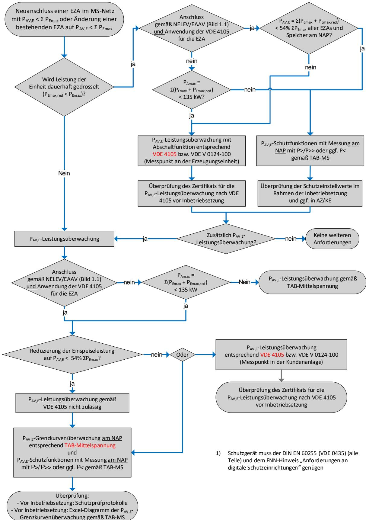
1) Schutzgerät muss der DIN EN 60255 (VDE 0435) (alle Teile) und dem FNN-Hinweis „Anforderungen an digitale Schutzeinrichtungen“ genügen
