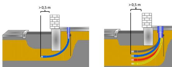
Netzanschlusskabel innerhalb von Gebäuden sind sichtbar zu verlegen, möglichst kurz auszuführen und ggf. mechanisch zu schützen (z.B. Kabelschutzrohr).
