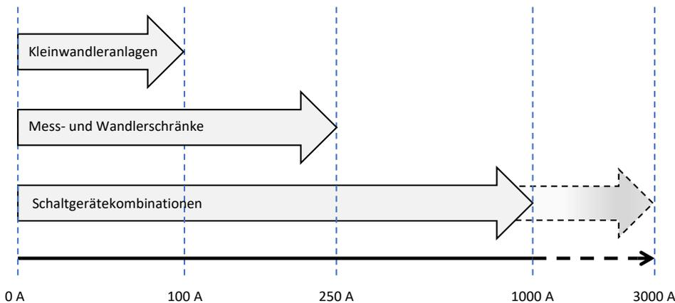
Zählerschränkkombinationen mit Zählerplätzen nach DIN VDE 0603-2-1 sind für Direktmessung bis max. 63A geeignet, darüber hinaus sind halbindirekte Messungen einzusetzen. Sofern eine Herstellererklärung für eine Niederspannungs-Schaltgerätekombinationen nach DIN EN 61439 (VDE 0660-600) vorliegt, sind auch Direktmessungen bis 100A möglich.
