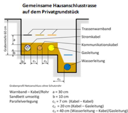
Die Kabel im Kabelgraben sind – sofern aufgrund des Kabeltyps notwendig – steinfrei einzusanden. Im Allgemeinen dürfen Kabeltrassen nicht überbaut werden (außer bei Kabelverlegung im Schutzrohr) und es dürfen keine tief wurzelnden Pflanzen vorhanden sein.
