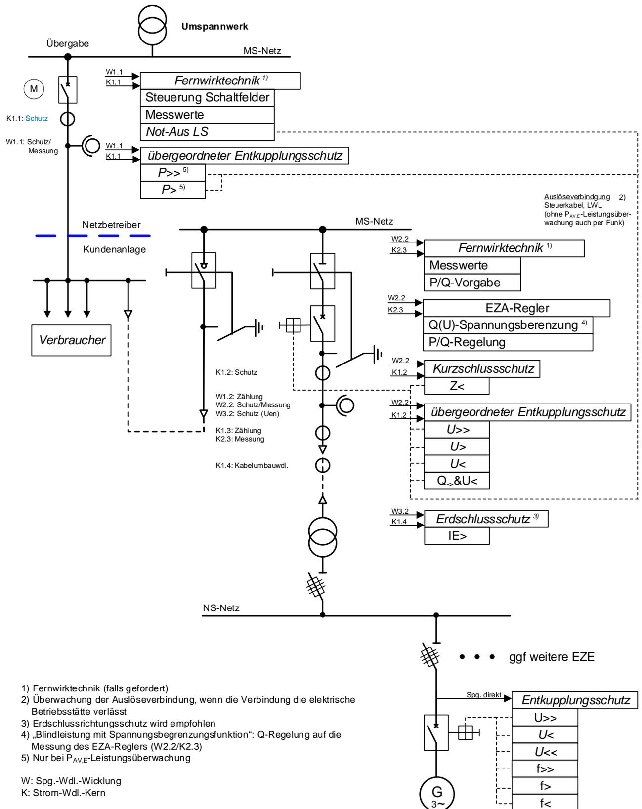
**Bild 16-Mischanlage** – Beispiel einer an eine **Schaltstation** im Mittelspannungsnetz angeschlossenen Kundenanlage mit Bezug und Erzeugungsanlage mit Lasttrennschalter und einer Erzeugungseinheit ohne Inselbetriebsmöglichkeit
