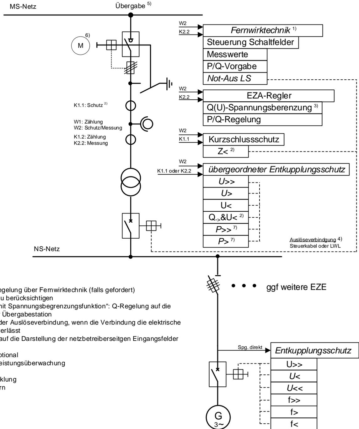
**Bild 12 Mischanlage** – Beispiel einer an das Mittelspannungsnetz angeschlossenen Kundenanlage mit Bezug und Erzeugungsanlage mit einer Erzeugungseinheit und automatischer Inselbetriebsmöglichkeit über niederspannungsseitigen Kuppelschalter (Anschluss nicht in UW bzw. Schaltstation)
