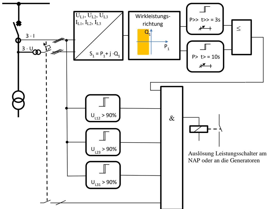
Bild 10.2: Schutzlogik für vertraglich vereinbarten reduzierten Einspeiseleistung
