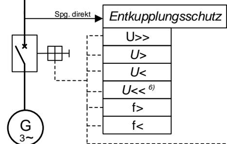
**Bild 13 Einspeisung** – Beispiel einer an ein Umspannwerk mittelspannungsseitig angeschlossenen Erzeugungsanlagen mit Leistungsschalter und Erzeugungseinheit ohne Inselbetriebsmöglichkeit
